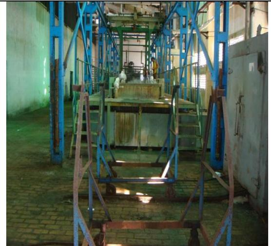
Fig. 2. Cubas de fosfatado en caliente donde se aplica el producto DISTIN 506 diluido.
